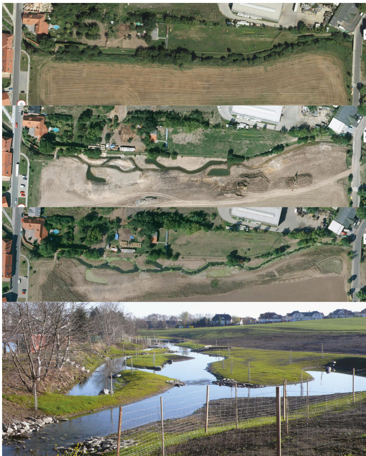
Obrázek 4: Příklad komplexní revitalizace říčního systému na Litovickém potoce se zcela novou kynetou koryta v nově vytvořené nivě, období let 2012 až 2016 (zdroj: www.mapy.cz a Vodní hospodářství, foto: Tomáš Just)
