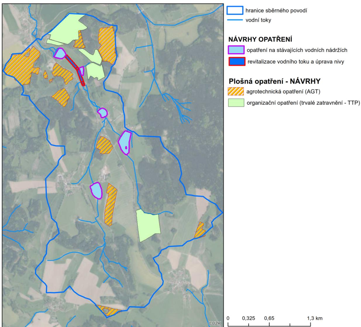
Obrázek 3: Navržená společná zařízení na ortofoto (Zdroj: ČÚZK)
