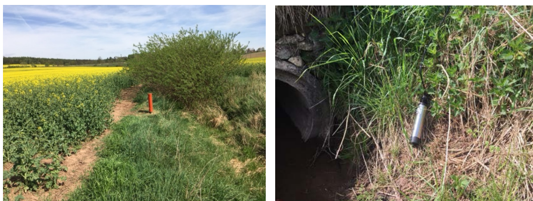
Obrázek 47: Konečná povrchová úprava v terénu po instalaci vlhkostního hnízda v Lišanech (vlevo); zákaloměrná sonda ESZK11 (vpravo)
