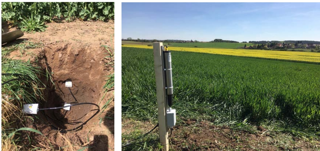
Obrázek 46: Instalované vlhkostní sondy CS655 v půdním profilu v hloubkách 10 cm, 35 cm a 60 cm pod povrchem, experimentální lokalita Lišany (vlevo); Hydro Logger H40G s GSM/GPRS modemem pro dálkový přenos dat (vpravo)
